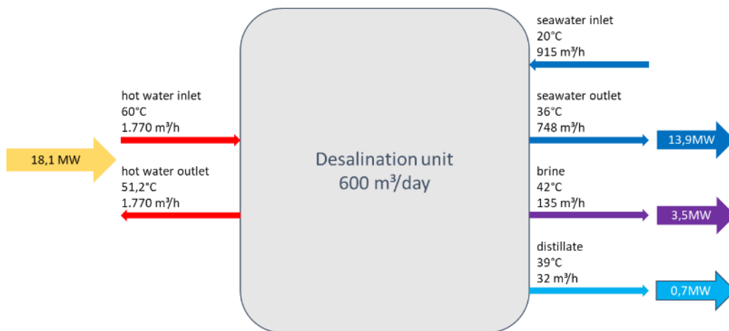
Abbildung 2-13: Massen- und Energiebilanz der MED auf einer Plattformebene
